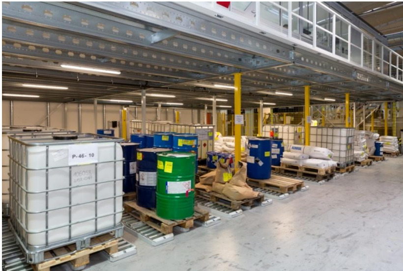
Bild 4 Gefällerollenbahnen mit bereitgestellter Ware
