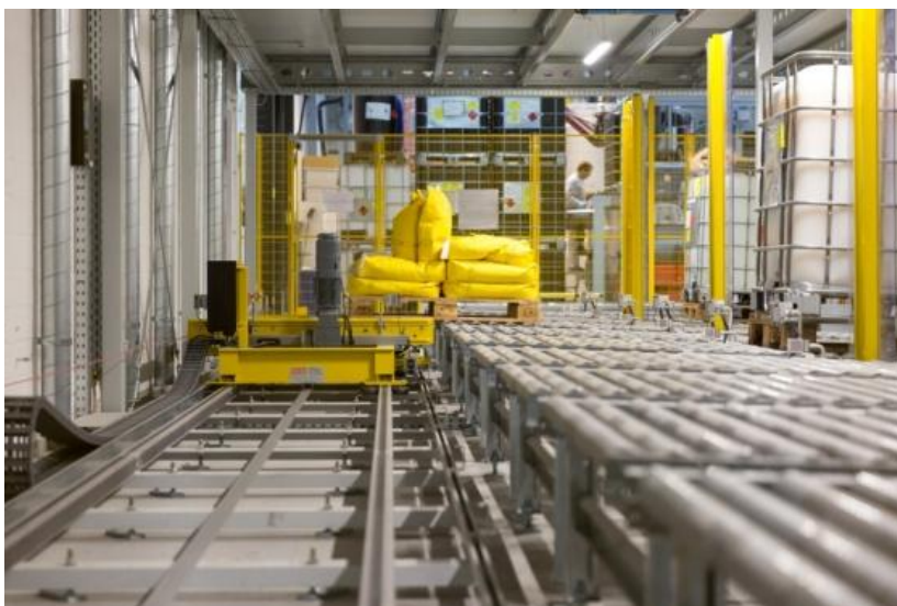
Bild 3 Übergabe von Querverfahrwagen auf Rollenbahn
